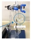
7 冷却水を確認します。冷却器にホースをつないで水を流して 各箇所に緩み・漏れがないことを確認します。
