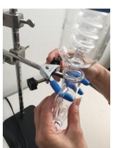
9 各部品の位置、全体の傾き、高さのバランスを確認してからムッフ(連結具)のネジをもう一度きつく締めて完全に固定します。
