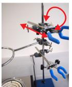
冷却器を上にあるクランプ(大)に固定します。クランプの両側のネジを緩め大きく開いてから冷却器を固定します。 クランプおよびムッフ(連結具)の位置や締め具合で冷却器
