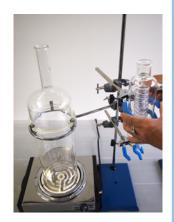
7 **D**連結管の両側についた **P**シリコンキャップを両手で持ちながら、一方を蒸留フラスコ(フタ)に、もう一方を冷却器に挿し込みます。この時、連結管は右に傾斜がついた状態となります。
