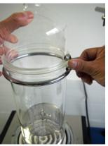
3 上から見た位置関係(写真参照)にも注意しながら、クランプの方向および前後の位置を調整します。
